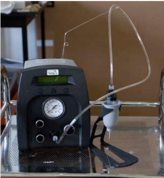
Abb. 11: Das Dosiergerät der Fa. Belo.
