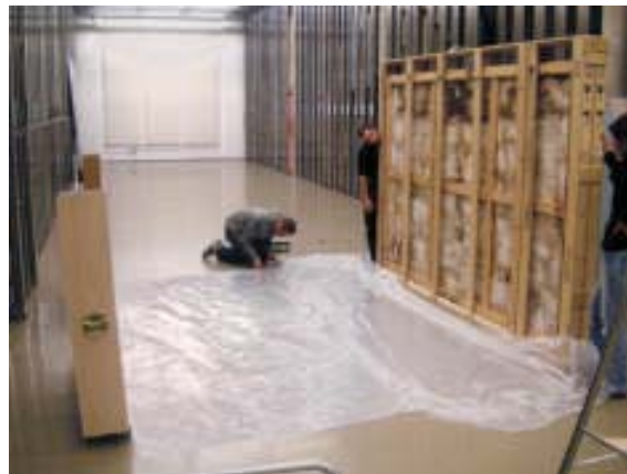
Abb. 54: Schweißen des Foliensacks mit dem erwünschten Mehrvolumen.
