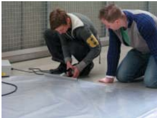
Abb. 41: Schweißen des Foliensacks.
