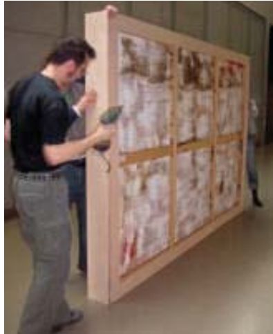
Abb. 39: Verschraubung der Bretter zu einem geschlossenen Kasten.
